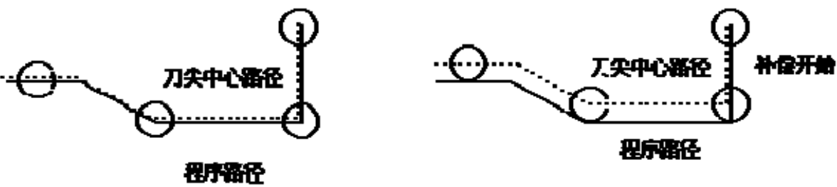
图 4-5 以刀尖中心编程时的刀具轨迹 没有刀尖半径补偿，假想刀尖轨迹将同于编程轨迹 使用刀尖半径补偿，将实现精密切削
