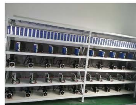
出厂前10000次以上高速正反老化
